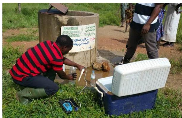
**Photo 7 : Prise d'eau du puits et analyse in situ de quelques paramètres**
